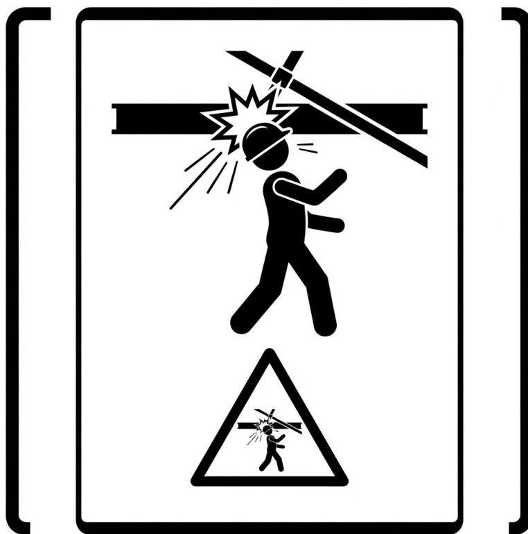
Рис. 3. Опасность удара о выступающие балки, трубопроводы и леса в стесненных зонах
